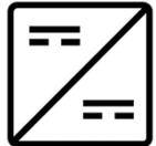
直流至直流轉換器(Chopper)：PV 優化器, 控制電源, 電瓶電力轉換
