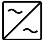
交流至交流轉換器(Cycloconverter)：變頻器、超大型風洞 (10 MW)
